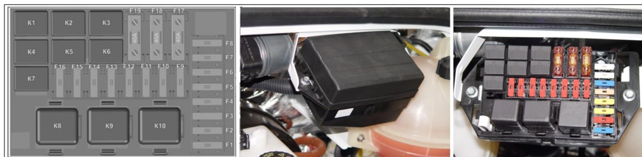
Рис. 7.57. Установка блока реле и предохранителей, расположенного в моторном отделении
