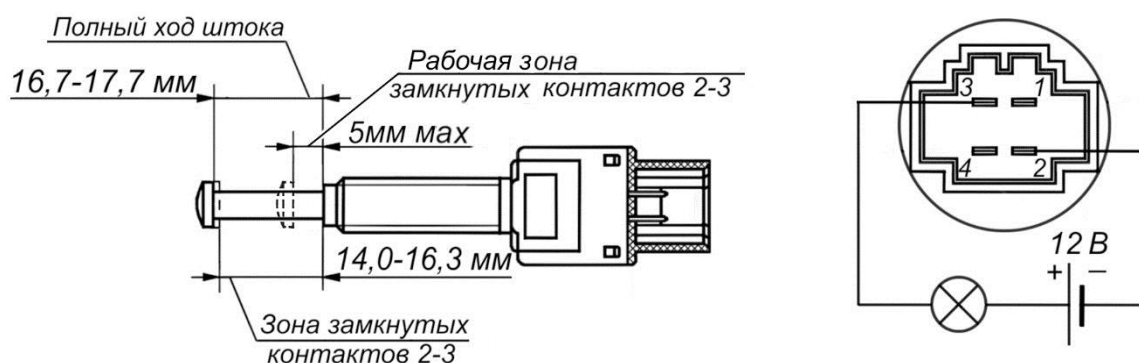
Рис. 7.28. Проверка выключателя сигнала положения педали сцепления
