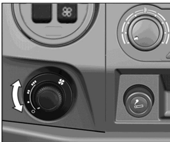
Рис. 7.40. Установка переключателя дополнительного отопителя
